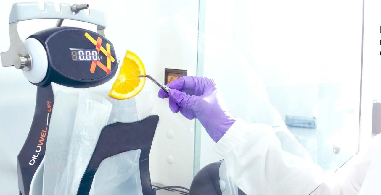
DILUWEL UP! est un diluteur gravimétrique rapide, précis et robuste qui dilue des échantillons solides avec le volume exacte de diluant, en quelques secondes.
